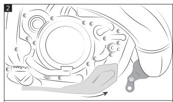
Remove the original skid plate. Smontare il sottomotore originale.
