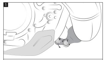
Remove the screw (2) and loosen the screw (1). Rimuovere la vite (2) ed allentare la vite (1).
